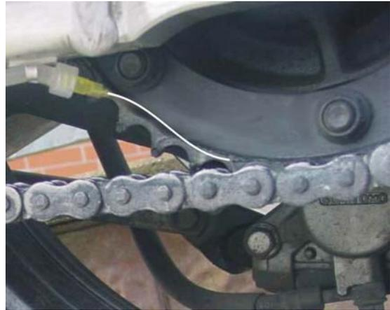
Zur Positionierung der Kanüle ist die Stelle zu wählen, an der die Kette auf das Kettenblatt läuft. Achte bei der Montage darauf, daß die Kanüle am Kettenblatt schleift und sich beim Rückwärtsschieben der Maschine nicht verhängt! Das ist oft Millimeterarbeit, lässt sich aber dank der Flexibilität der Edelstahl-Kanüle bewerkstelligen.
